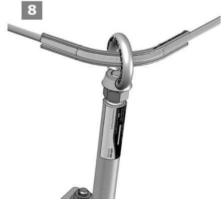
Position Eckseilschutz kontrollieren /
