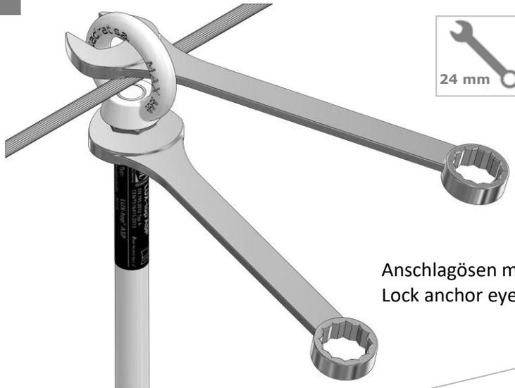
Anschlagösen mittels Konterung sichern! /
