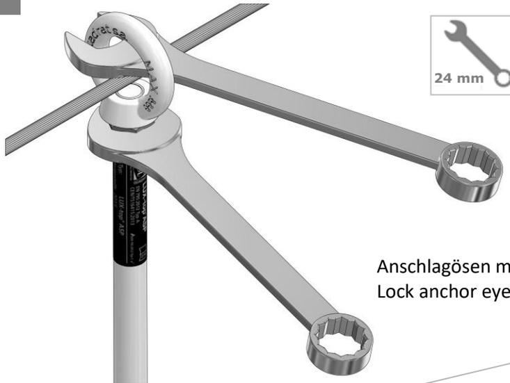
Anschlagösen mittels Konterung sichern! /
