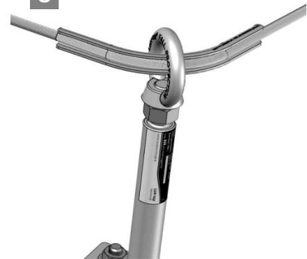
Position Eckseilschutz kontrollieren /
