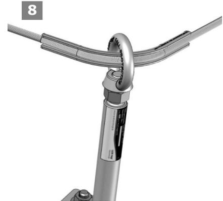
Position Eckseilschutz kontrollieren /
