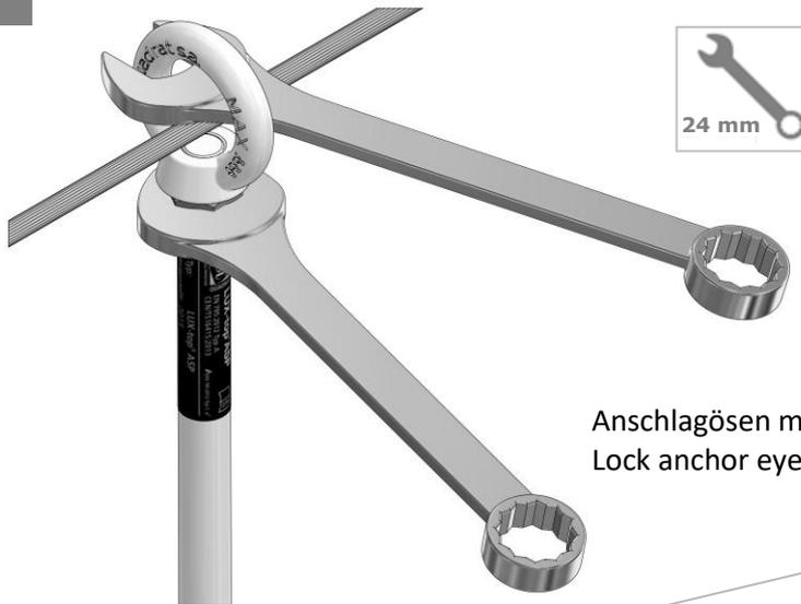
Anschlagösen mittels Konterung sichern! /
