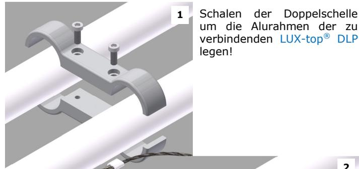
Beide Schalen der Doppelschelle-DLP mittels Innensechskantschrauben (M6) verbinden!
