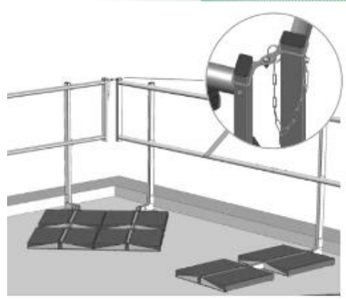
Bild 21: LUX-top® G-T Eckausbildung mittels Eckset Fig. 21: LUX-top® G-T corner formation using corner set
