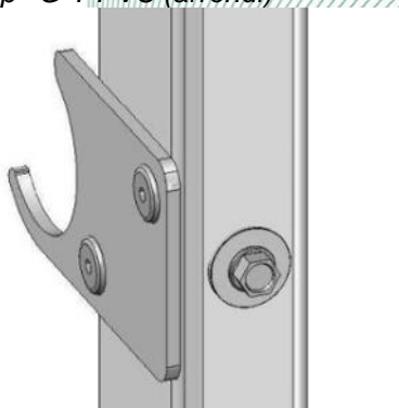
Bilder 18-19: LUX-top® G-T Geländerholmhalter (links), Geländerholmhalter variabel (rechts)
