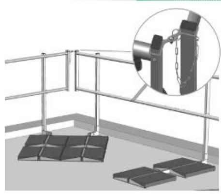
Bild 21: LUX-top® G-T Eckausbildung mittels Eckset Photo 21 : Configuration d'angle LUX-top® G-T par set d'angle
